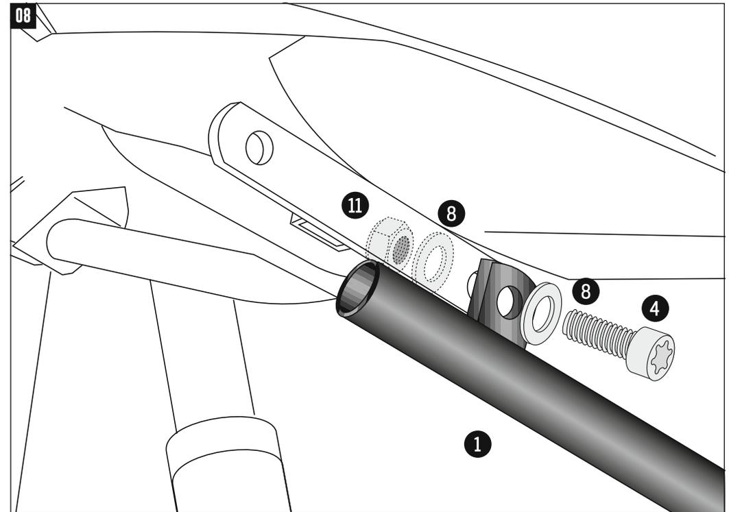
**Montage des Tanksschutzbügels links vorne:**
