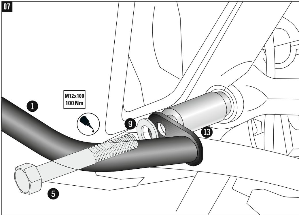
**Montage des Tanksschutzbügels links hinten:**
