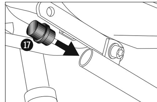
Das Verbindungsstück  $\varnothing 25$  in das Rohrende des montierten linken Motorschutzbügels fügen.
