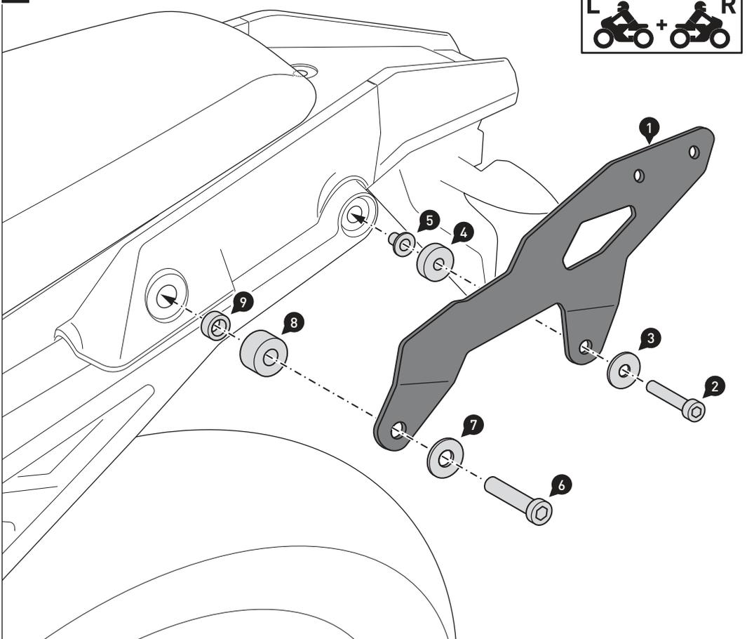
Montieren Sie die Anbaubleche (1) **beidseitig** am Fahrzeug.
