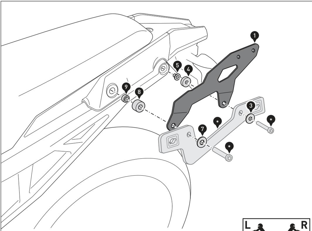
**⚠ HINWEIS:** Um den Gepäckträger zusammen mit dem SW-MOTECH PRO Seitenträger oder dem SW-MOTECH SLC Seitenträger zu montieren, verwenden Sie die dort beigelegten Schrauben (\*).
