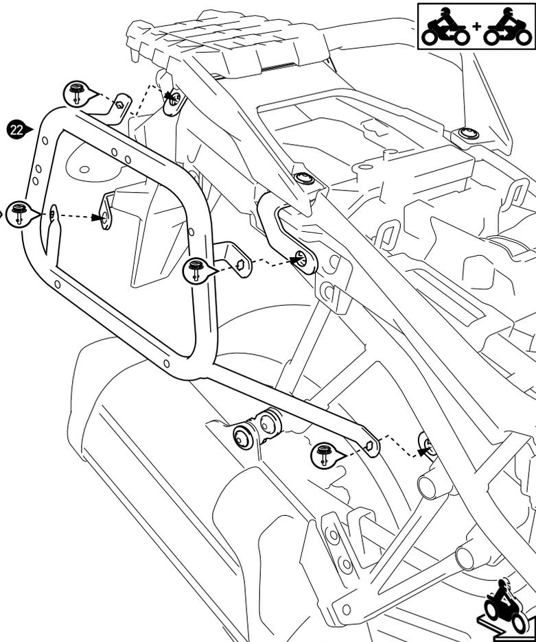
**HINWEIS:** Die Montage ist rechtsseitig dargestellt. Wiederholen Sie die Montage mit den entsprechenden Teilen auf der linken Fahrzeugseite analog zur rechten Fahrzeugseite.
