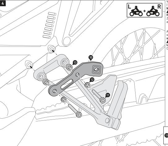
Verschrauben Sie die Anbaubleche (10) mit den Fußrastenhaltern beidseitig am Fahrzeug.
