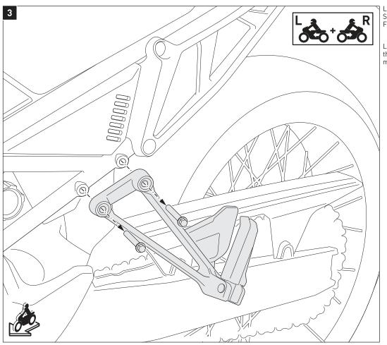
Lösen Sie **beidseitig** die gezeigten Schrauben und entfernen Sie die Furßrastenhalter.
