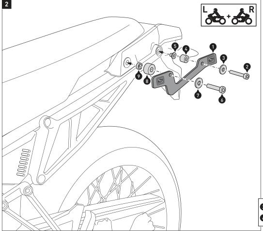
Verschrauben Sie die Anbaubleche (1) beidseitig am Fahrzeug. WARNUNG: Verwenden Sie flüssige Schraubensicherung! Ziehen Sie die Schrauben noch nicht
