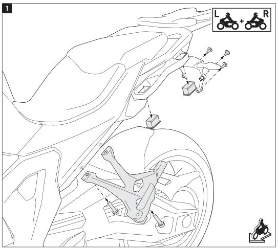
Entfernen Sie die Soziusfußrastenhalter **beidseitig** vom Fahrzeug. Entfernen Sie anschließend die gezeigten Stecker **beidseitig** vom Fahrzeugheck.
