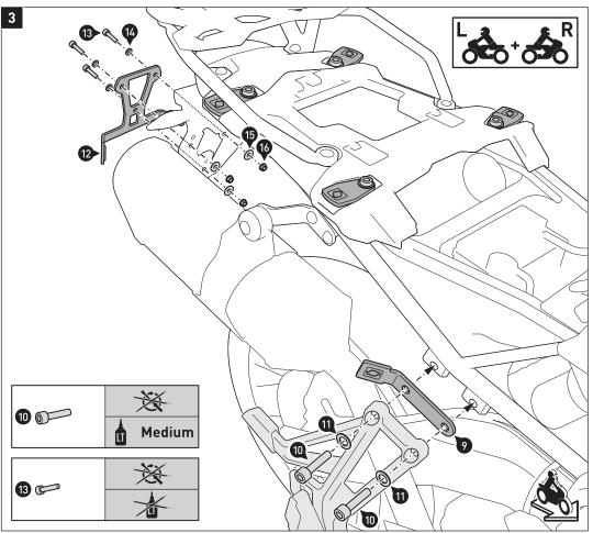
Verschrauben Sie beidseitig die Befestigungslaschen (9) mit den Soziusfußrastenhaltern am Fahrzeug, wie in der Zeichnung gezeigt
