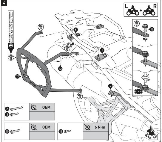
Verbinden Sie die Kofferträger (17) mit den Schnellverschlüssen (18) an dem Querverbinder (12) und den Befestigungslaschen (1), (5) und (9), wie in der Zeichnung gezeigt. Sichern Sie die Schnellverschlüsse (18) mit den Sicherungsscheiben.
