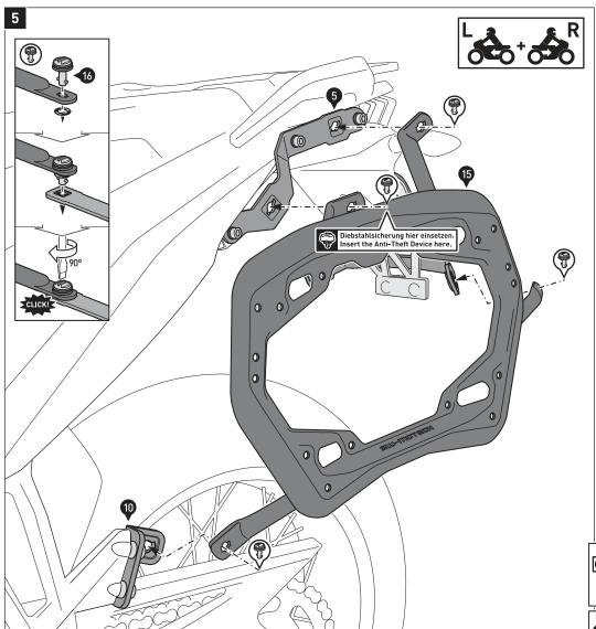
Verbinden Sie die Seitenträger (15) mit den Schnellverschlüssen (16) an den Befestigungslaschen (5), (10) und (11) sowie dem Querverbinder
