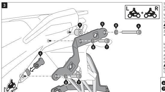
Schieben Sie die Einschubmuttern (4) beidseitig in die Aufnahmen des Fahrzeughecks.
