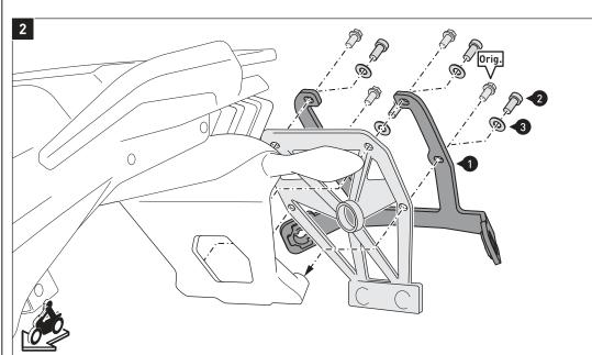
⚠ HINWEIS: Bei Modellen ab 2021 sind die original Schrauben (Orig.) nicht enthalten. Verwenden Sie stattdessen die Schrauben (2) und die Unterlegscheiben (3).
