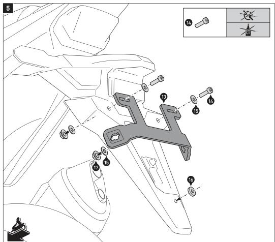
Verschrauben Sie den Querverbinder (13) am Fahrzeug, wie in der Zeichnung gezeigt, Ziehen Sie die Schrauben noch nicht an
