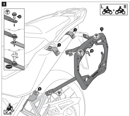
Verbinden Sie die Kofferträger (11) mit den Schnellverschlüssen (12) an den Befestigungslaschen (1) und (5)/(8), sowie dem Querverbinder (13)
