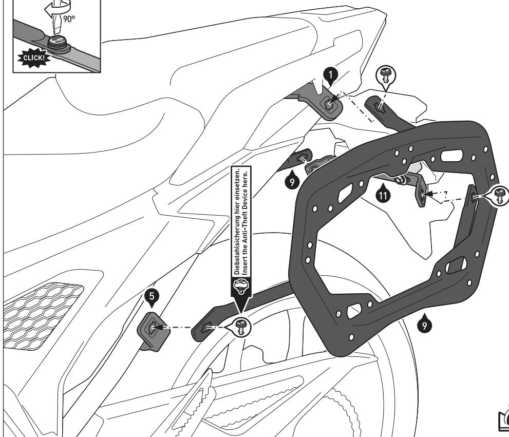
Verbinden Sie die Kofferträger (9) mit den Schnellverschlüssen (10) an den Befestigungslaschen (1) und (5) und dem Querverbinder (11). Sichern Sie die Schnellverschlüsse mit den Sicherungsscheiben.
