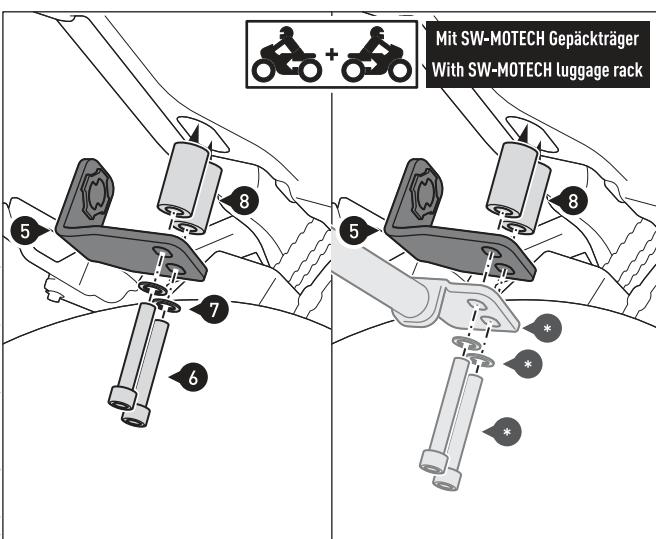
**⚠️ HINWEIS:** Bei gleichzeitig montiertem SW-MOTECH Gepäckträger entfallen die Schrauben (6) und Unterlegscheiben (7). Verwenden Sie stattdessen die Teile (\*) des Gepäckträgers. Montieren Sie die Haltestreben des Gepäckträgers zwischen den Befestigungslaschen (5) und Unterlegscheiben (\*).
