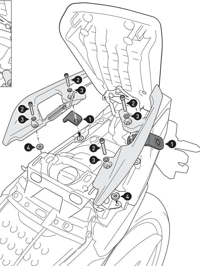
Verschrauben Sie die Befestigungslaschen (1) mit den Sozius-Haltegriffen am Fahrzeug, wie in der Zeichnung gezeigt. Halten Sie die Distanzbuhsen (4) mit etwas Fett in Position.
