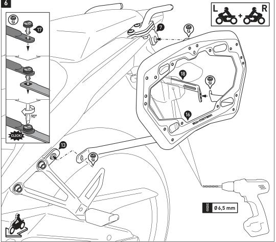
Verbinden Sie die Kofferträger (16) mit den Befestigungslaschen (7) und (13); verwenden Sie die Schnellverschlüsse (17) wie in der Detailzeichnung gezeigt. Verbinden Sie nun die hinteren Befestigungsausleger mit dem Querverbinder (18). Benutzen Sie auch hier die Schnellverschlüsse (17).
