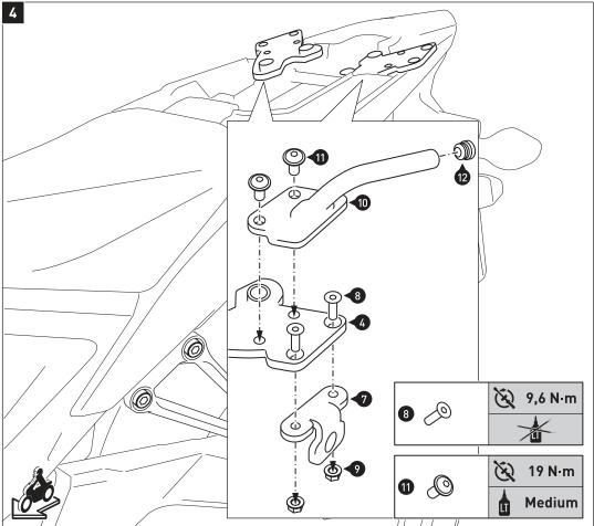
Verschrauben Sie die Befestigungs-laschen (7) an den Anbaublechen (4), wie in der Detailzeichnung gezeigt. Ziehen Sie die Schrauben wie
