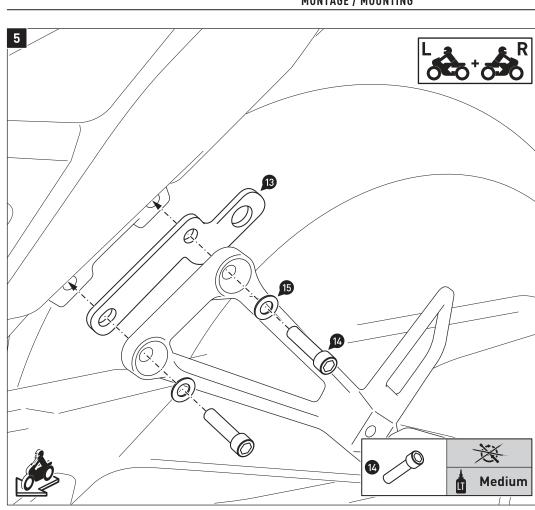
Lösen Sie Schrauben der Soziusfußrasten und entfernen Sie diese vom Fahrzeug.
