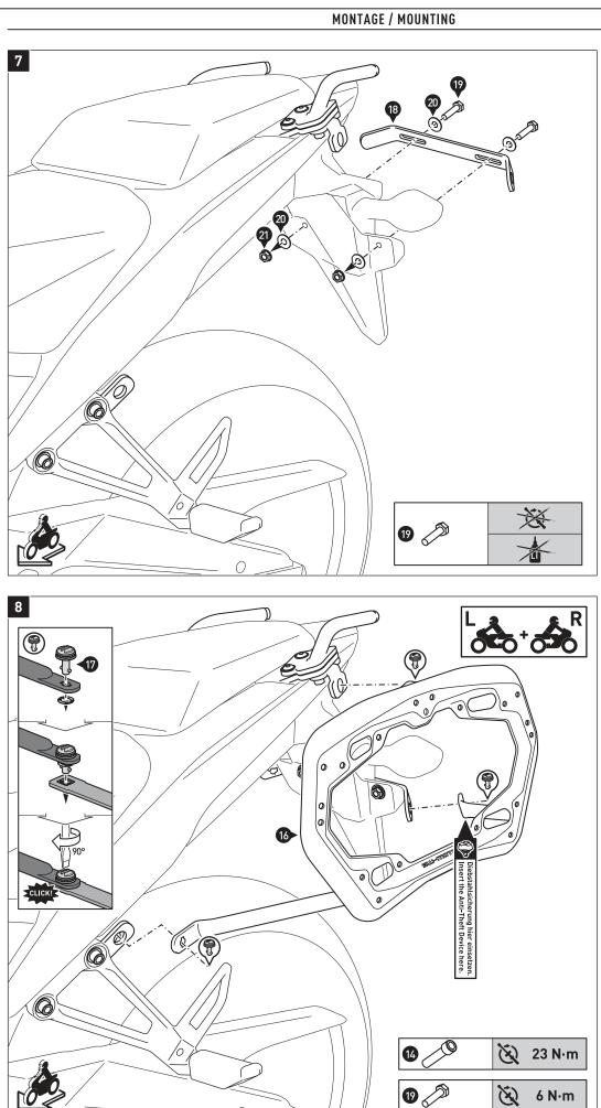
Verschrauben Sie den Querverbinder (18) am Kennzeichenhalter, wie in der Zeichnung gezeigt. Ziehen Sie die Schrauben noch nicht an.
