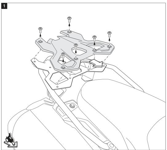
Lösen Sie die Schrauben und entfernen Sie den original Gepäckträger in Fahrtrichtung vom Fahrzeug, wie in der Zeichnung gezeigt.
