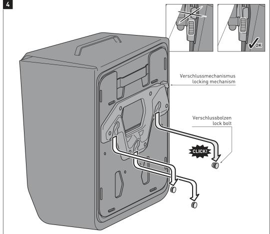
Setzen Sie die Arretierungsöffnungen des Schnellverschlusssystems auf die Führungsbolzen des Adapterkit für SysBag (separat erhältlich).
