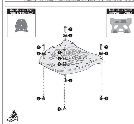
Adapterplatte für ALU-RACK Gepäckträger und Adapterplatte für SysBag 30
